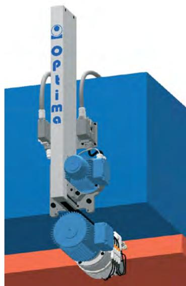
Per il fissaggio impiegare 4 viti a esagono in-cassato M12x30 classe di resistenza 8.8 con rondella e 2 spine Ø10x20 (non comprese nella fornitura).
