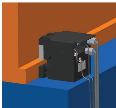
Die Befestigung erfolgt durch zwei Schrauben, ISO 4762 der Festigkeitsklasse 10.9 (nicht im Lieferumfang enthalten).
